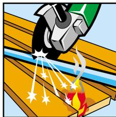
Die Gefahr der unbeabsichtigten Zündung brennbarer Stoffe ist nicht nur in der näheren und weiteren Umgebung der Arbeitsstelle, sondern auch in darunter und darüber liegenden Räumen gegeben. Flammen und Funken können in Staub und Fugen lang anhaltende Schwelbrände verursachen, die erst Stunden nach Beendigung einer brandgefährlichen Tätigkeit zum Ausbruch kommen können.
