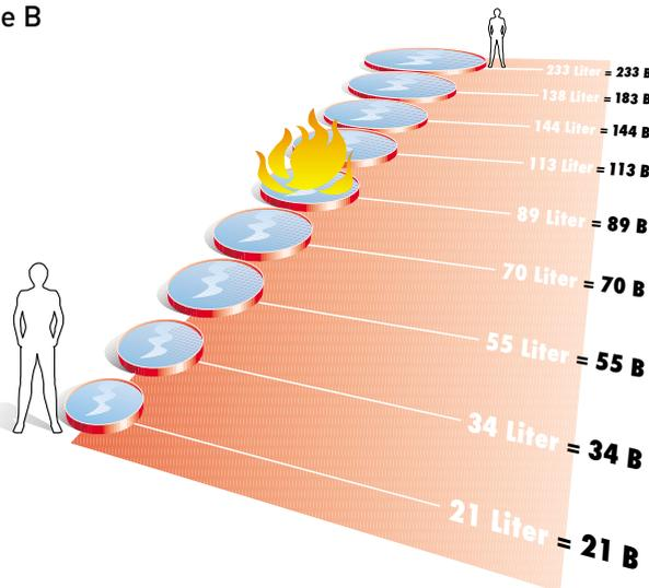
Prüfobjekt: Genormter zylindrischer Stahlbehälter zur Aufnahme eines genau definierten Flüssigkeitsvolumens. Das Flüssigkeitsvolumen des Brandstoffes in Liter (jeweils 2/3 Brennstoff und 1/3 Wasser) entspricht der Maßzahl, mit der das Löschvermögen eines Feuerlöschers für die Brandklasse B definiert ist.
