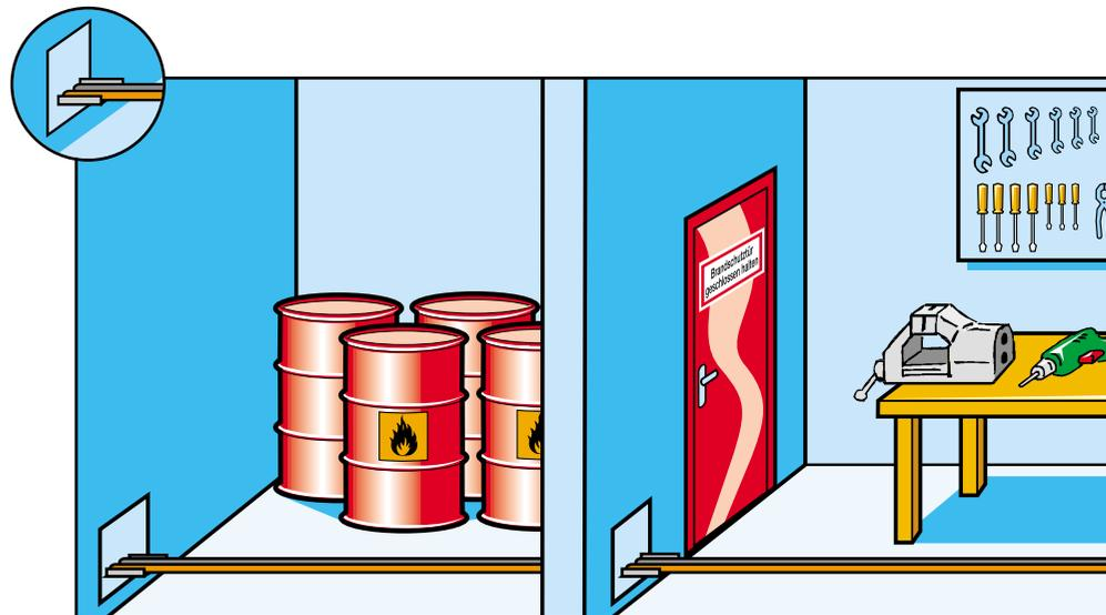
Durchtrittsstellen von Kabel-, Rohr-, Lüftungsleitungen etc. müssen mit Brandschutz-Schottungen abgeschlossen werden. Diese Maßnahme wird vielfach nicht beachtet!
