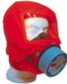
Die Fluchthaube ist ein Rettungsgerät zum Verlassen eines brennenden Gebäudes über verqualmte Gänge und Stiegen. Voraussetzung ist, dass die Luft noch genügend Sauerstoff zum Atmen enthält. Das Filter hält Schweb- und Schadstoffe zurück und hat eine Einsatzdauer von ca. 15 Minuten. Die Sichtscheibe in der Haube schützt Gesicht und Augen gegen Hitze, kurzzeitige Flammeneinwirkung und gegen reizenden und ätzenden Brandrauch. Fluchthauben sind nur zur Einmalbenützung vorgesehen.
