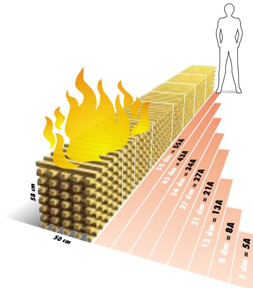
Prüfobjekt: Genormter Holzstapel aus Kiefernholz, 14 Schichten, Höhe 58 cm, Breite 50 cm. Die Länge des gelöschten Holzstapels in Dezimetern entspricht der Maßzahl, mit der das Löschvermögen eines Feuerlöschers für die Brandklasse A definiert ist.
